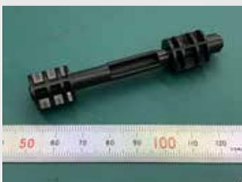
▲ 旋盤加工後に MC 加工
