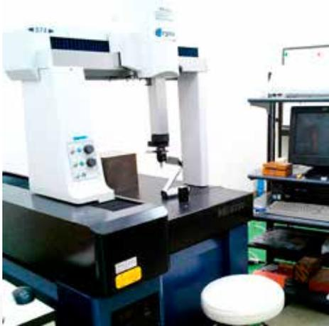
▲三次元測定機(門型プローブ接触式)
